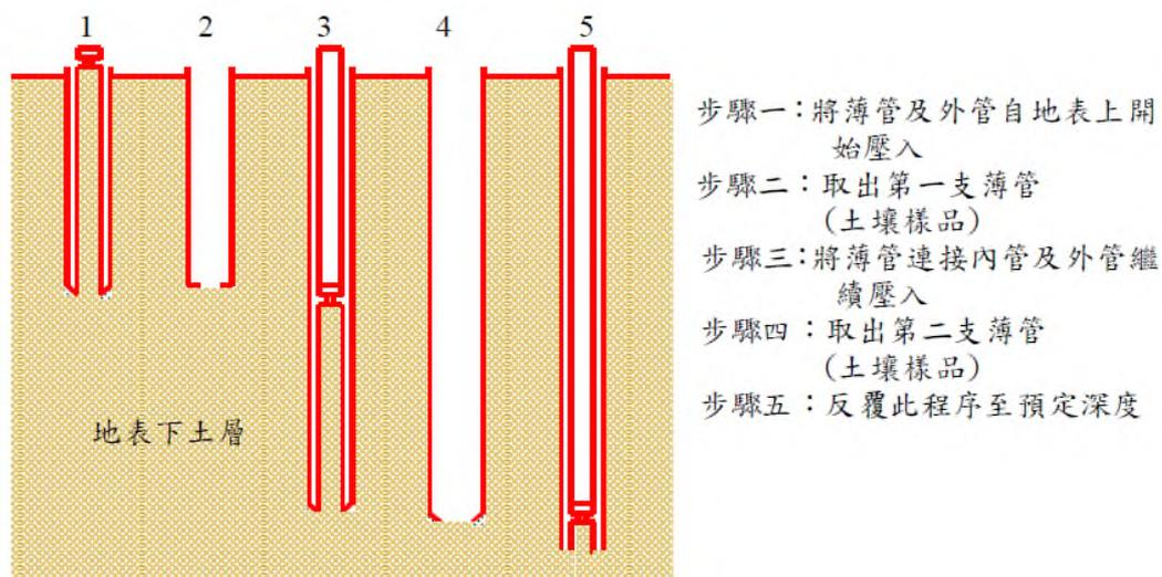
圖 1.5.1-4 直接貫入雙套管法採集土壤示意圖
