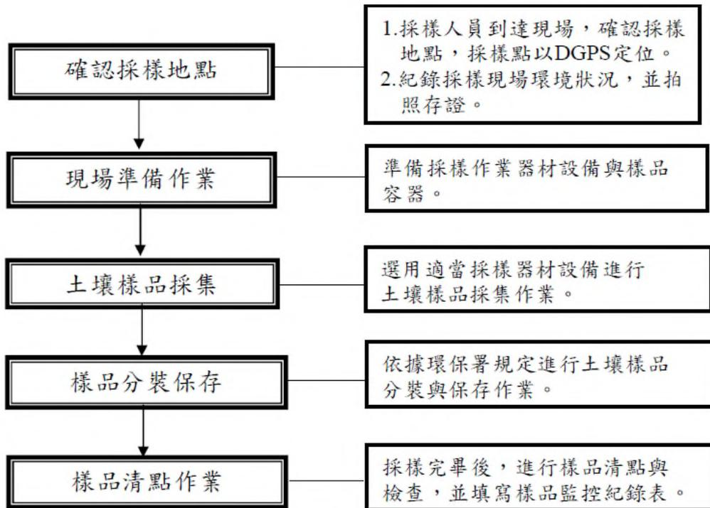
圖 1.5.1-3 土壤現場採樣作業流程
