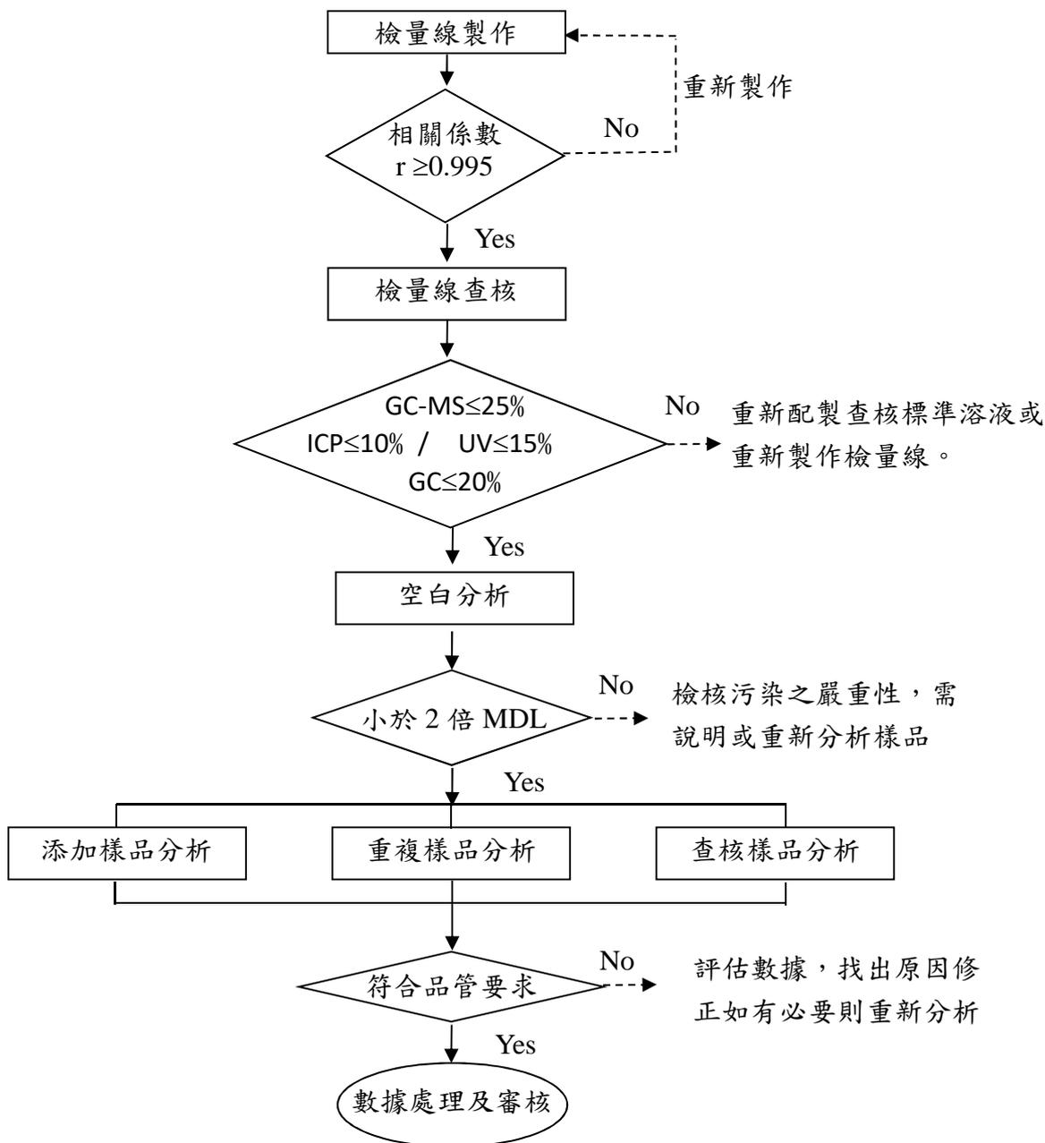
圖 1.5.2-2 檢驗室品質管制流程圖
