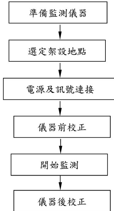
圖 1.5.1-1 噪音監測儀器架設流程
