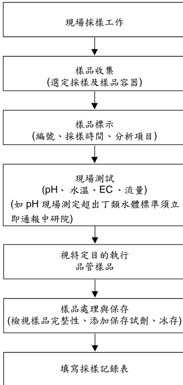
圖 1.5.1-2 水質採樣作業流程圖
