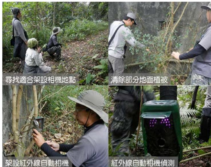
圖 2.2.2-1 紅外線自動相機架設流程
