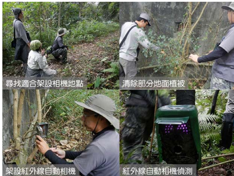
圖 2.2.2-3 紅外線自動相機架設流程
